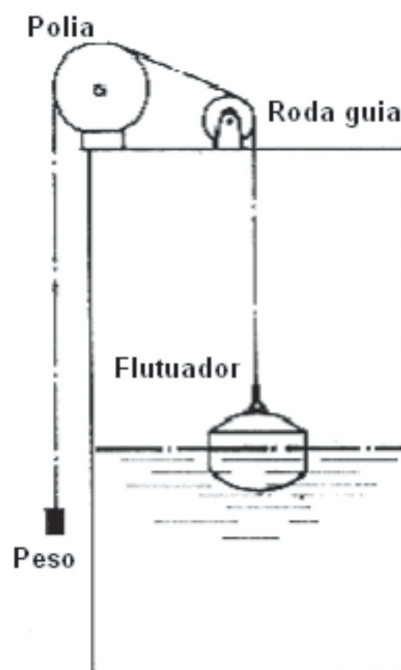
Figura 66 – Medidores de nível tipo flutuador livre (SENAI. ES,1999a, p. 93)
